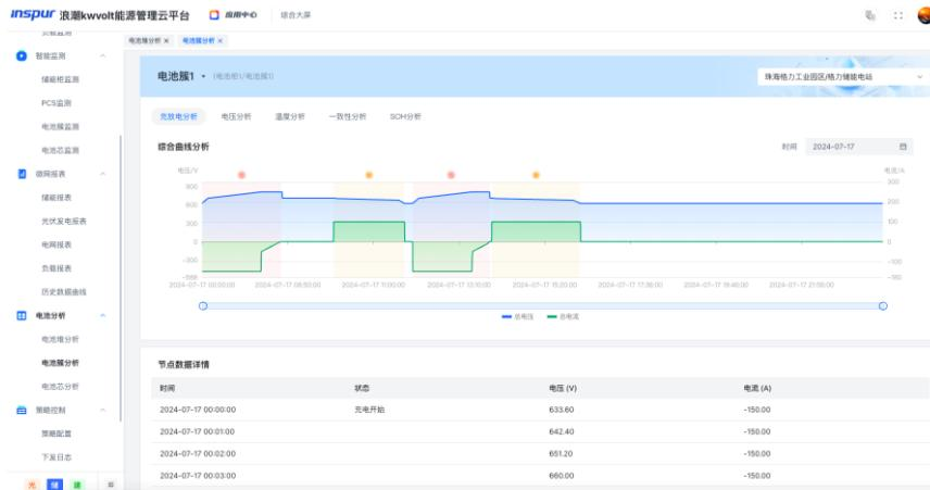
电池簇分析-电压分析展示了单体电压分析、单体压差预警分布。单体电压分析展示了本日单体电压平均值、单体电压最大值、单体电压最小值变化曲线，可点击切换时间范围查询数据，最长可选择 7 天；单体压差预警分布展示了各电芯电压情况，可点击切换时间范围查询数据。
