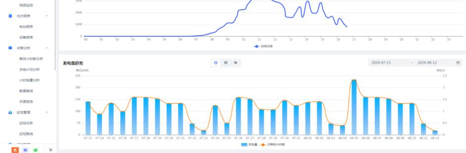
设备运行页面展示了通讯状态、运行状态、交流侧实时数据、直流侧实时数据、发电功率曲线、发电量趋势。
